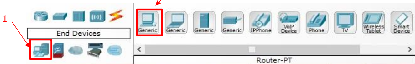
شکل 3-11 طریقه‌ی انتخاب PC در Packet Tracer
